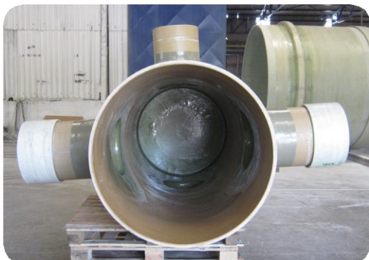
Vnitřní pohled na uzavřené dno GRP šachty
