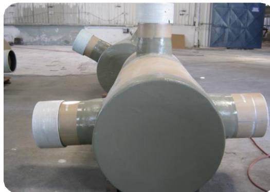
Vnější pohled na uzavřené dno GRP šachty
