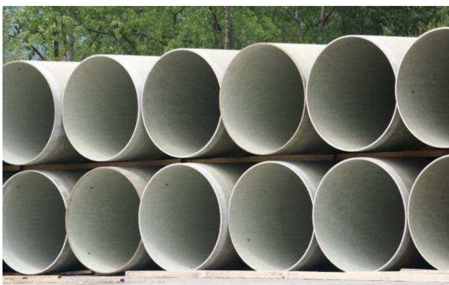
Obrázek 5: Uložení trubek na sebe (2 vrstvy)
